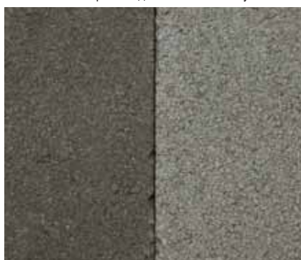
Камень слева, с нанесенным герметиком Alphasith StoneGloss T через 2 года в естественных условиях
